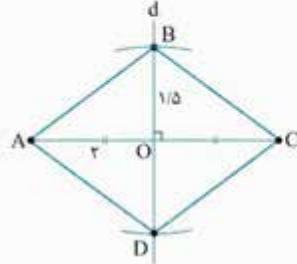
می‌دانیم در لوزی قطرها عمودمنصف یکدیگرند؛ یعنی هم  $AC \perp BD$  و هم نقطه برخورد دو قطر (O) وسط دو قطر است. بنابراین ابتدا یکی از قطرها (مثل  $AC = 4$ ) را رسم می‌کنیم. سپس عمودمنصف این قطر را می‌کشیم (خط d) و به مرکز O وسط قطر AC و به شعاع نصف قطر دیگر یعنی  $\frac{BD}{2} = \frac{3}{2}$ ، دو کمان (یا یک دایره) می‌زنیم تا این عمودمنصف را در B و D قطع کند.
