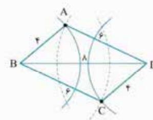
**مطابق شکل (۱)** متوازی‌الاضلاع  $ABCD$  با قطرهای  $AC = 3$  و  $DB = 4$  رسم شده است. چون قطرها منصف یکدیگرند،  $OA = OC = 1/5$  و  $OB = OD = 2$ ؛ پس برای رسم این متوازی‌الاضلاع، ابتدا دو خط  $d$  و  $d'$  را که در نقطه  $O$  متقاطع هستند، می‌کشیم. به مرکز  $O$  و شعاع  $1/5$ ، دو کمان می‌زنیم تا خط  $d'$  را در نقاط  $A$  و  $C$  قطع کنند.
