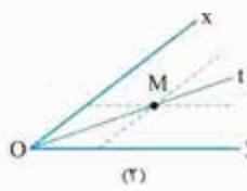
پس مطابق شکل (۲)، خطی به موازات ضلع  $Ox$  و فاصله یک از آن، درون زاویه  $xOy$  و همچنین خطی به موازات  $Oy$  و همین فاصله از آن، باز هم درون زاویه  $xOy$  رسم می‌کنیم. محل برخورد دو خط جدید، نقطه  $M$  خواهد بود. چون فاصله این نقطه از دو ضلع مساوی است، پس  $\hat{M}$  روی نیمساز زاویه  $xOy$  واقع است. با اتصال نقطه  $M$  به رأس  $O$ ، نیمساز  $xOy$  رسم می‌شود.
