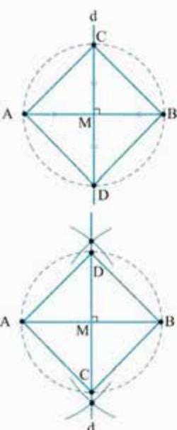
حال ابتدا قطر  $AB = 12$  را رسم می‌کنیم، سپس عمودمنصف این قطر را می‌کشیم (خط d)؛ سپس به مرکز نقطه M (محل برخورد d و AB) و به شعاع نصف قطر  $(\frac{12}{2} = 6)$  دایره‌ای می‌زنیم تا d را در نقاط C و D قطع کند. چهارضلعی ABCD مربع است.
