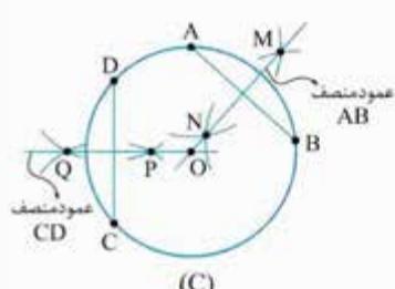
۱۲- می‌دانیم عمودمنصف هر وتر درون یک دایره از مرکز دایره می‌گذرد. پس مطابق شکل رویه‌رو، دو وتر دلخواه AB و CD را درون دایره رسم می‌کنیم (بهتر است این دو وتر، نقطه اشتراکی نداشته باشند، البته برای رسم جذاب‌تر)، سپس عمودمنصف وترهای ذکر شده را رسم می‌نماییم تا یکدیگر را در O قطع کنند؛ این نقطه مرکز دایره است.
