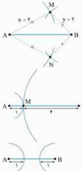
۱- مطابق شکل نقطه A و B به فاصله ۴ سانتی‌متر از هم واقع‌اند. برای این‌که دو نقطه در صفحه وجود داشته باشد که از A، فاصله x و هم‌چنین از B، فاصله y داشته باشد، باید  $x + y$  از فاصله A و B بزرگ‌تر باشد، یعنی  $x + y > 4$ . مثلاً فرض می‌کنیم  $x = 3$  و  $y = 2$ ؛ یعنی اگر به مرکز A و شعاع ۳ و به مرکز B و شعاع ۲ کمان‌هایی بزنیم، یکدیگر را در M و N قطع می‌کنند، این دو نقطه جواب مسئله‌اند.
